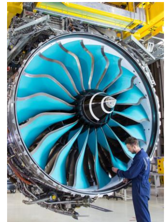
UltraFan®実証用エンジン搭載用 カーボンチタン ファンブレード (出典:ロールス・ロイス)
