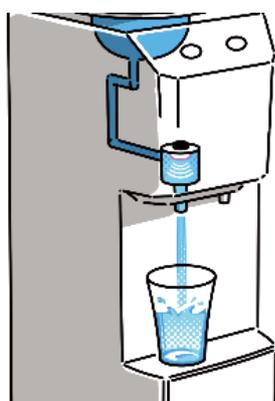
PearlAqua Micro™ A モデルは、本製品のノズルを機器の吐水口に接続して使用するほか、本製品のノズル自体を機器の吐水口として使用するという設置方法にも対応します。
