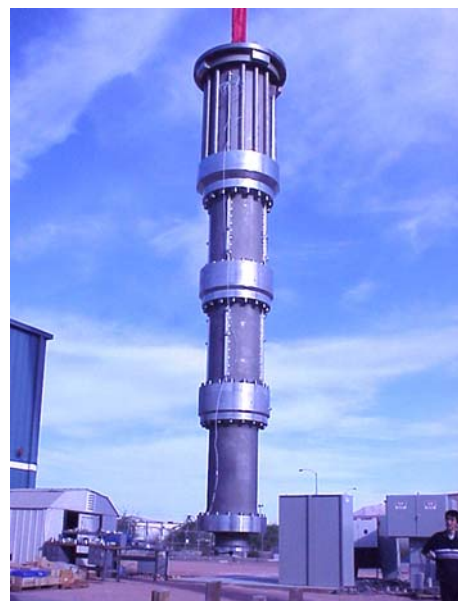
LNG受入基地用クライオジェニックポンプ
